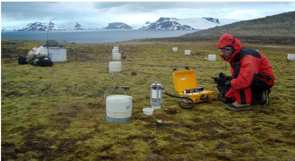
**Figura 11:** Sistema automatizado LI-8100 (Licor) acoplado a colares de PVC instalados em cada ponto de amostragem, Antártica marítima.
