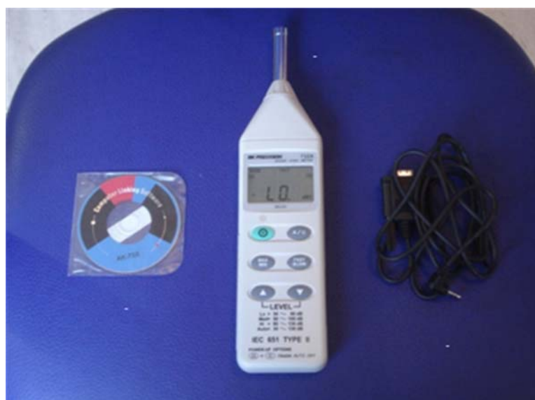
Figura 8: A- decibelímetro modelo BK Precision 732A Sound Level Meters; B- cabo de transmissão de dados; C- cd com manual e software de instalação. Fonte: acervo pessoal.
