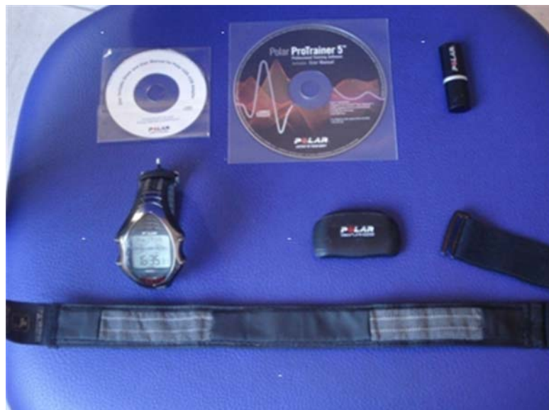
Figura 10: Componentes do Polar modelo RS800CX: A- faixa com frequencímetros, B- transmissor, C- relógio, D- manual e cd de instalação do programa Polar Protrainer 5, E- Driver Polar IrDA USB Adapter (interface de emissão de infravermelho), F- cd de instalação da interface de emissão de infra-vermelho. Fonte: acervo pessoal.
