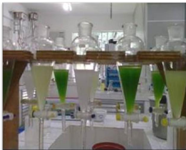
Figura 35. Extração alcoólica no material vegetal fresco. Etapa de partição utilizando clorofórmio para promover a separação da fase polar (aquosa) e apolar (clorofórmio)
