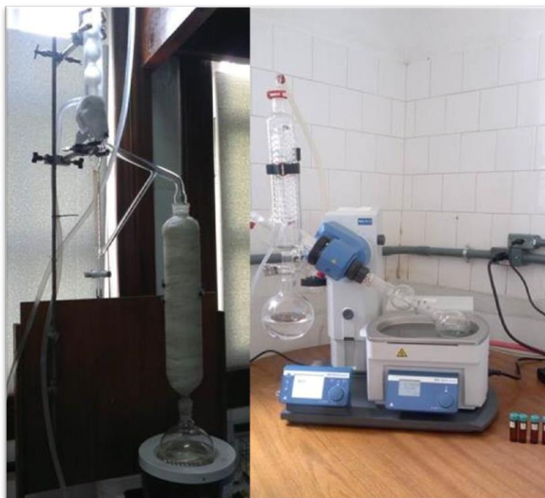
Figura 36. Extração e evaporação do óleo essencial. Extração por arraste a vapor (à esquerda) e concentração do óleo essencial em rotavapor (à direita)
