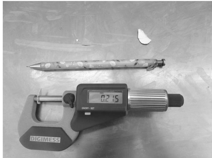
**Figura 13:** Micrômetro
