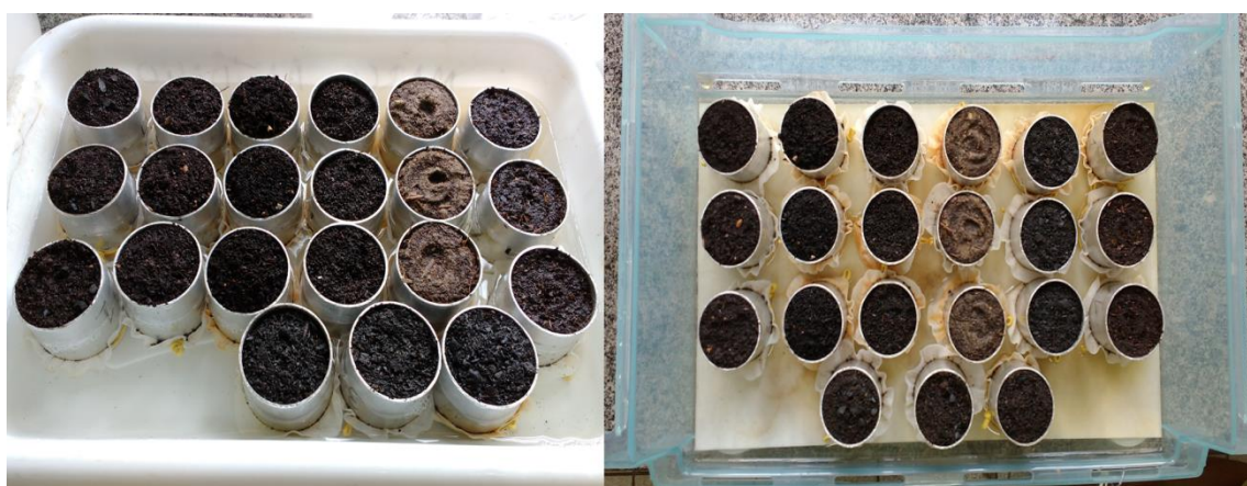
Figura 6. Cilindros contendo os substratos, mantidos em água por 24 horas para saturação completa e posterior colocação na mesa de tensão por 24 horas a 60 cm de altura d'água. Imagem: Luiz Fernando de Sousa Antunes, 2016.
