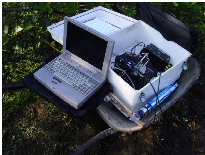
Figura 5. Detalhe do equipamento TDR no campo para o monitoramento da umidade do solo.
