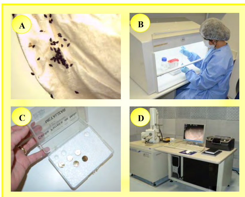
Figura 13. A- Ovos de Aedini em papel filtro; B- Processamento de ovos na Capela de exaustão; C- Ovos montados em suportes metálicos recobertos com ouro; D-Microscópio eletrônico de varredura.
