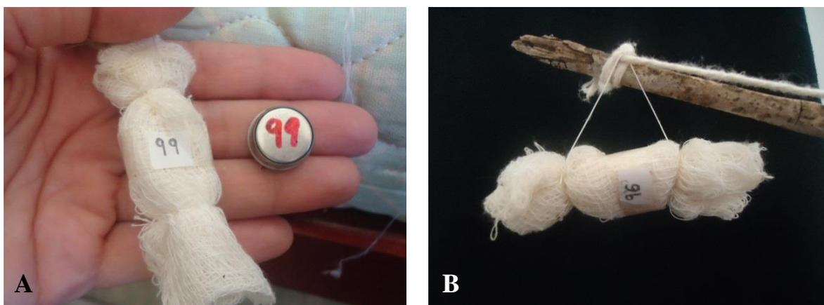
**Figura 2.3** - Sensor iButton modelo DS1402D. (A) Sensor numerado e embrulho de gaze. (B) Sensor embrulhado e amarrado à vareta.
