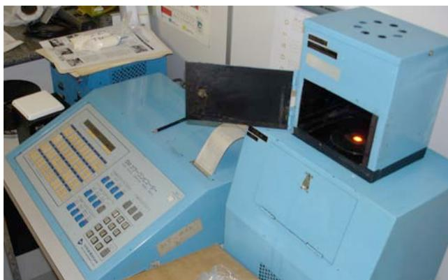
**Figura 8** Colorímetro usado na determinação da cor dos filmes.
