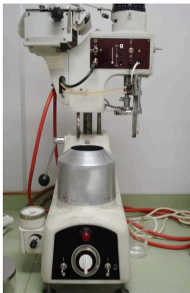
**Figura 5** Viscoamilógrafo usado na preparação das soluções filmogênicas.
