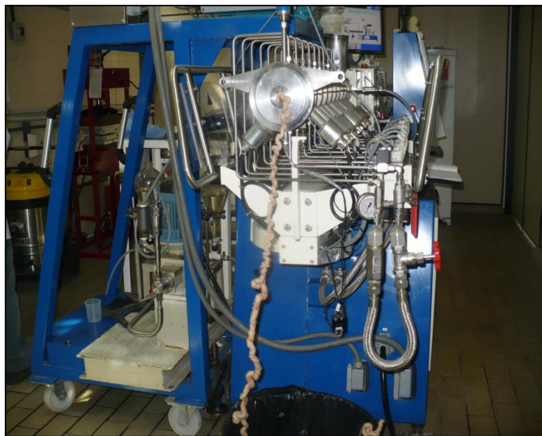
Figura 1. Extrusora de rosca dupla Clextral Evolun HT25 (Firminy, França).
