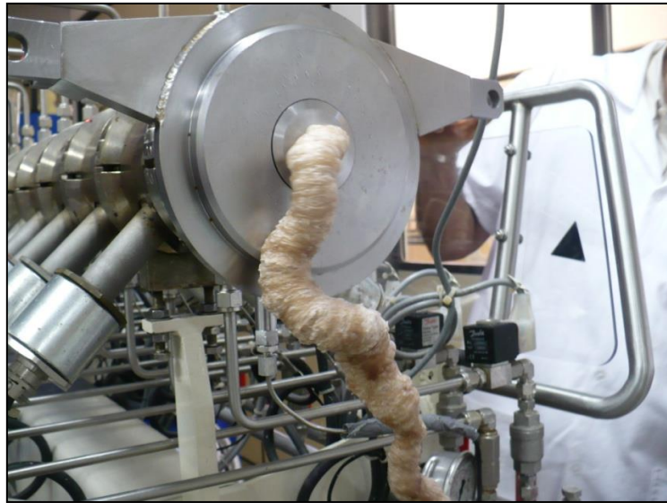
Figura 2. Processo de extrusão, extrudado saindo da matriz da extrusora.
