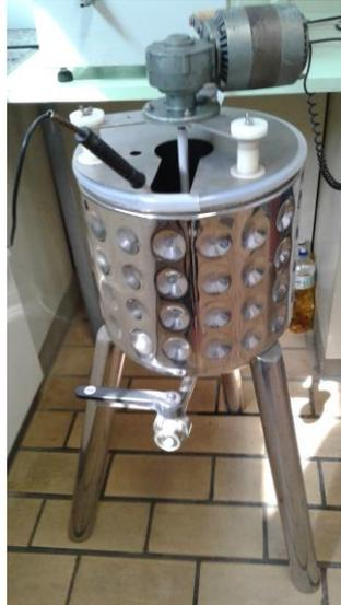
**Figura 6: Tanque encamisado com capacidade de 20 L**
