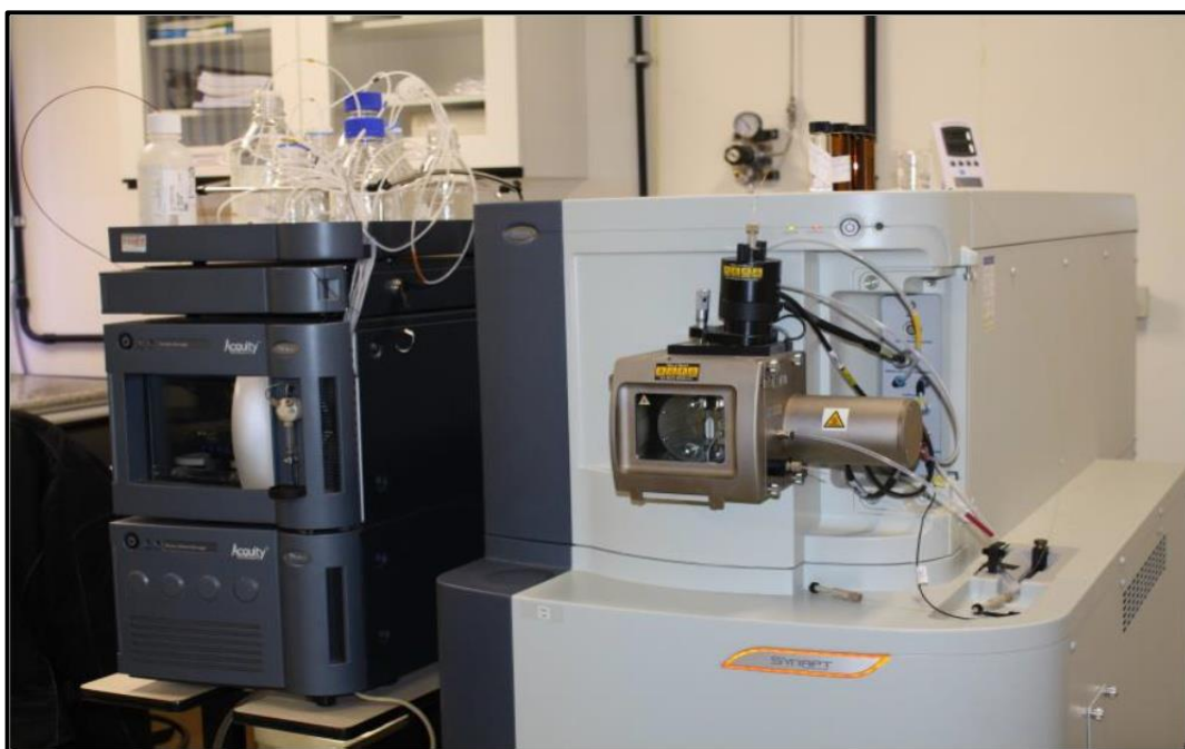
Figura 25. Sistema Acquity UPLC ® acoplado ao espectrômetro de massas Synapt ® modelo G1 com analisadores QTDV (SCHULZ, 2014).
