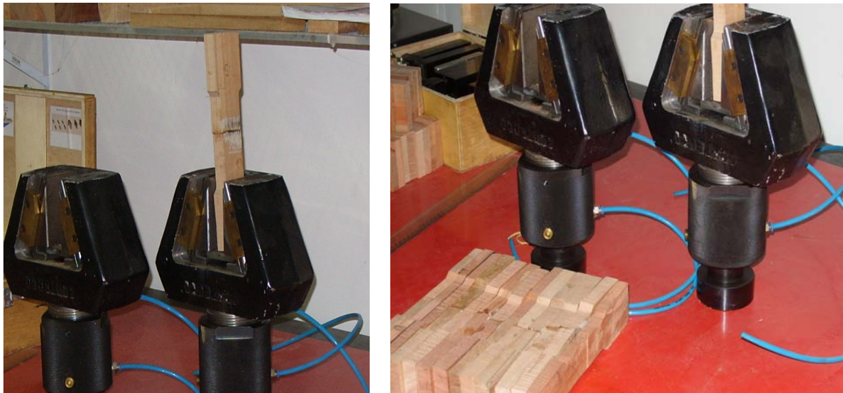
Figura 16. Detalhes dos corpos-de-prova nos ensaios de resistência das emendas (tração).
