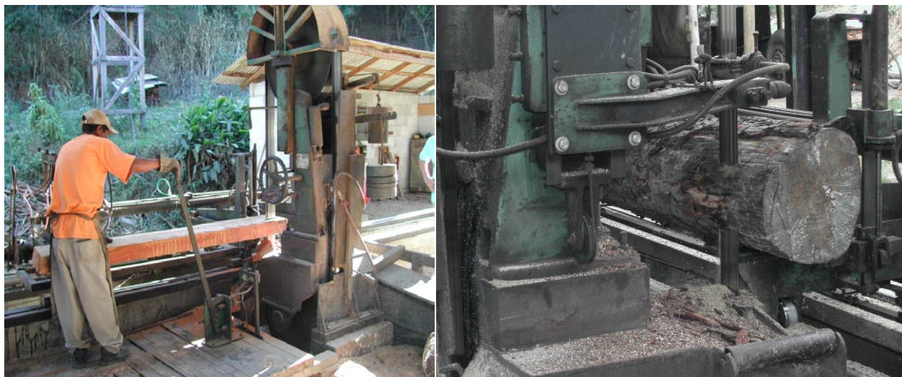
Figura 2. Detalhes do desdobro das toras.
