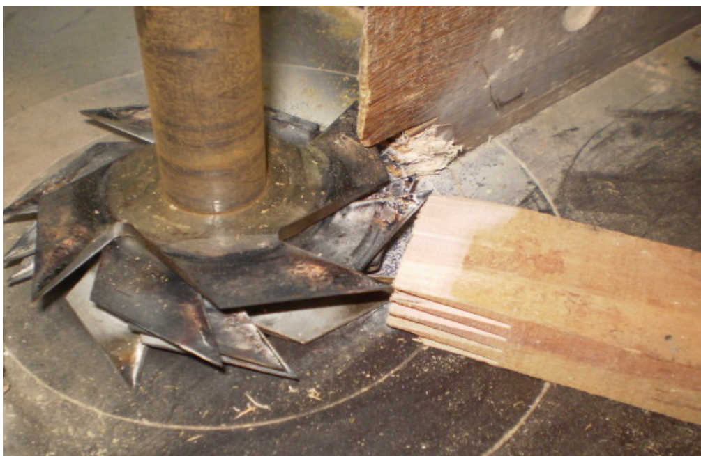
Figura 11. Confeção das emendas do tipo “finger-joint”.
