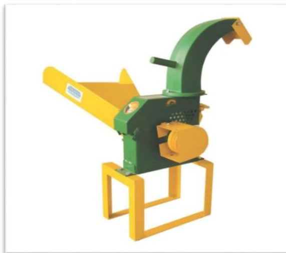
Figura 5. Modelo ilustrativo do picador utilizado para trituração do resíduo de poda urbana. Fonte: google/imagens.
