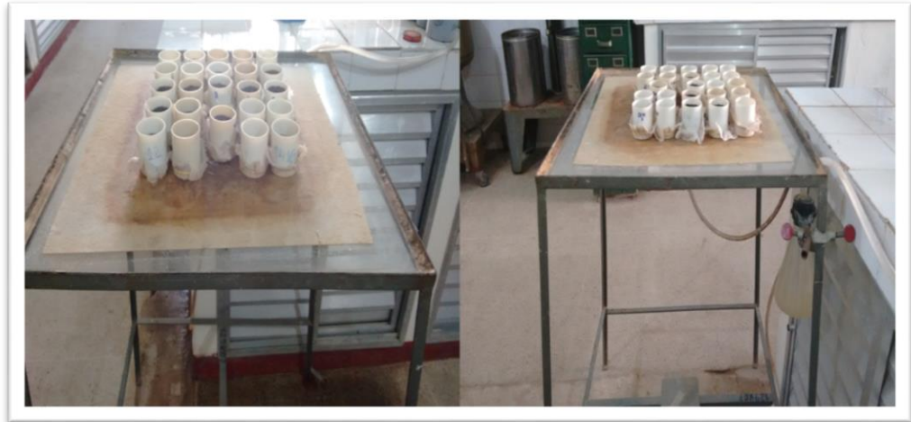
Figura 13. Mesa de tensão com as amostras a 10 cm de tensão.
