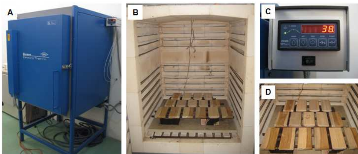
Figura 9. (A) Forno mufla elétrico laboratorial, da marca Linn Elektro Therm, com dimensões de 600 x 600 x 700 mm. (B) Interior do forno mufla e posicionamento das amostras de madeira. (C) Sistema de controle de temperatura e tempo de tratamento. (D) Amostras de madeira antes do tratamento termorretilificador.
