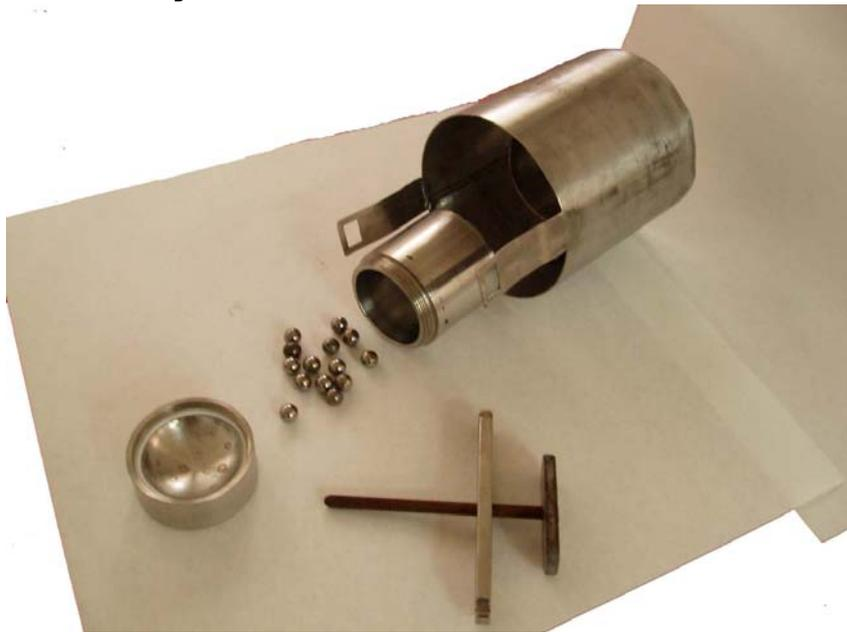
Figura 6. Sistema de moagem desmontado
