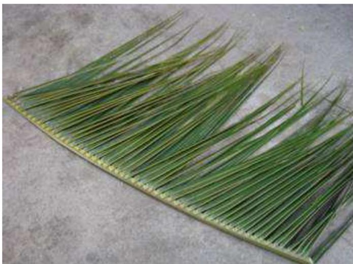
**Figura 4** – Palha de coqueiro dobrada na forma de pente para cobertura de telhado.
