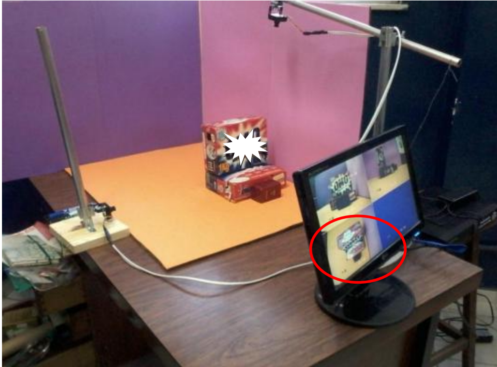
Figura 37- Apoios menores com tubos metálicos e base de madeira. Planos de papelão revestido com EVA: plano horizontal (laranja); plano vertical (roxo) e plano de perfil (rosa).
