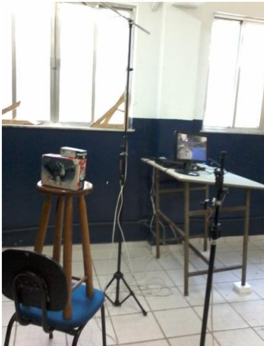
Figura 33- Apoio das câmeras com suporte de banners. Improvisação para suporte dos objetos para adequação da altura das câmeras.
