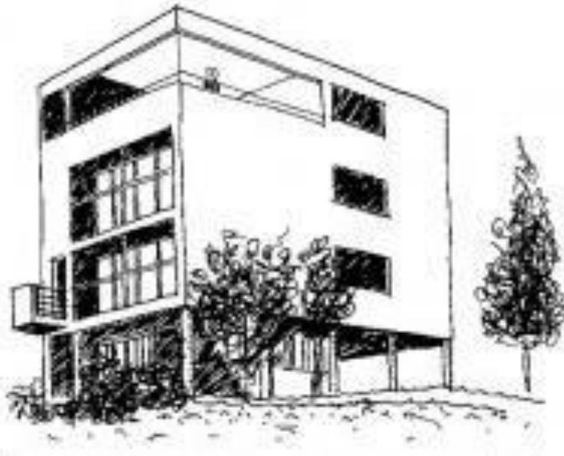
Figura 8 - Perspectiva cônica (com dois pontos de fuga) da casa Citrohan Mark II de Le Corbusier. As retas se encaminham para o ponto de fuga, desenho mais semelhante à nossa visão.
