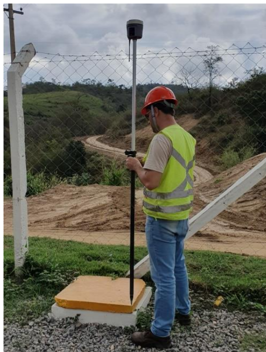
Figura 34. Coleta de ponto de referência com receptor CHC I80.
