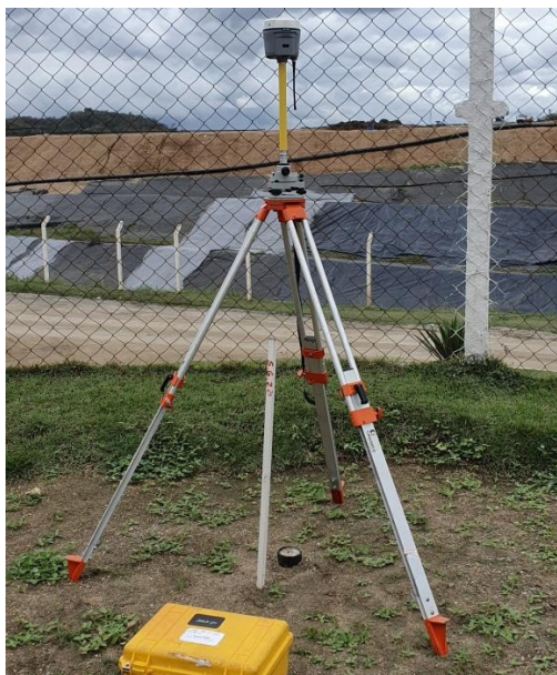
Figura 35. Ponto Base com receptor instalado.
