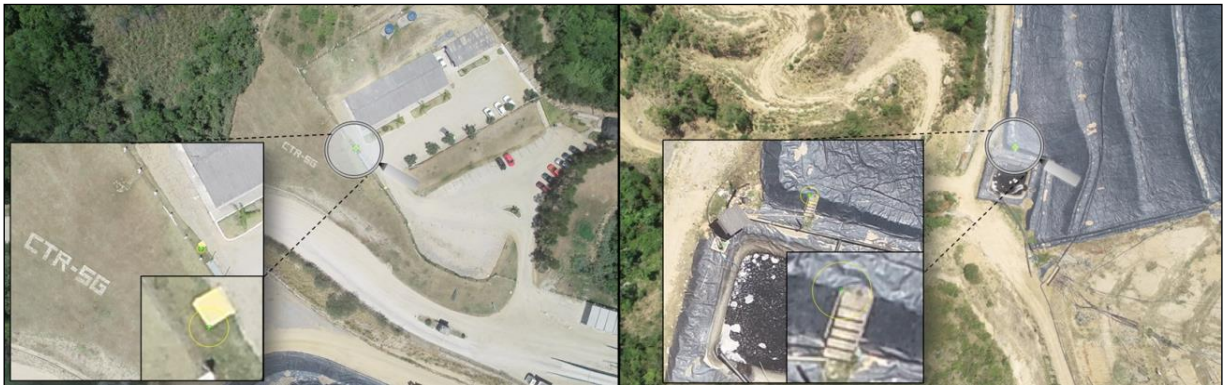
Figura 33. Pontos de controle (GCP). A esquerda, uma caixa de drenagem e a direita a quina de uma escada.
