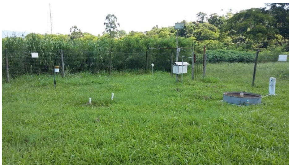
Figura 1. Estação meteorológica, localizada na Fazendinha Agroecológica, utilizada para medição de temperatura, radiação, velocidade do vento, precipitação.
