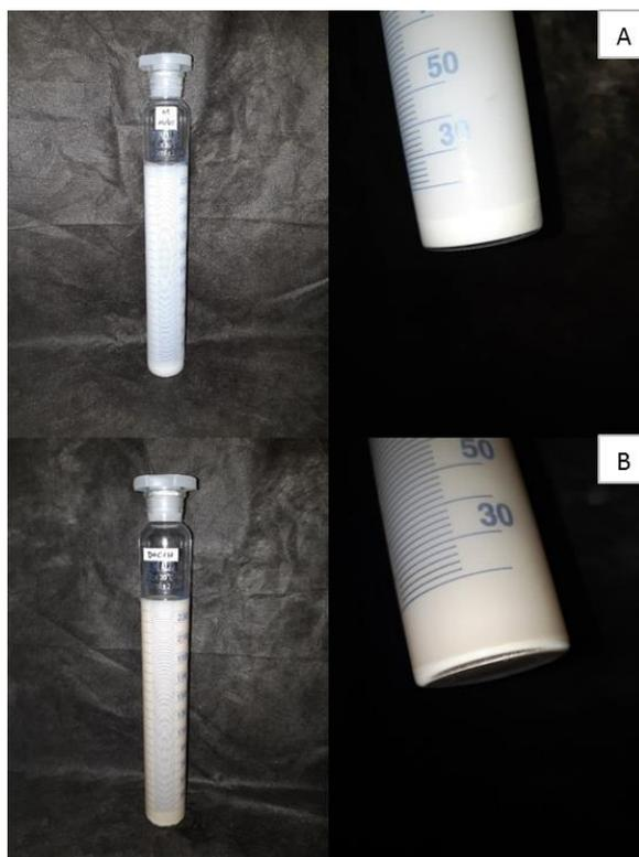
**Figura 13.** Exemplo de formação de sedimentos pelo ensaio estático no teste de compatibilidade de calda. Seropédica/RJ, 2019.
