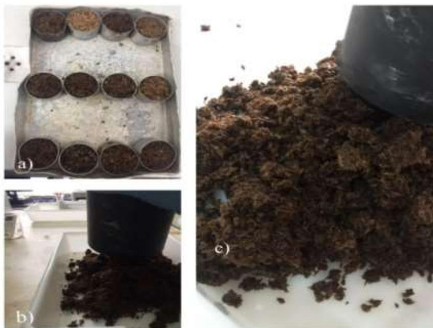
**Figura 13.** Metodologia de amostragem do experimento. (a) cadinhos de alumínio com massa coletada durante a amostragem (b) massa em processo de compostagem sendo retirada do vaso interno do reator e (c) redistribuição e homogeneização da massa feitos no 0 dia, 3º dia, 9º dia e 21º dia.
