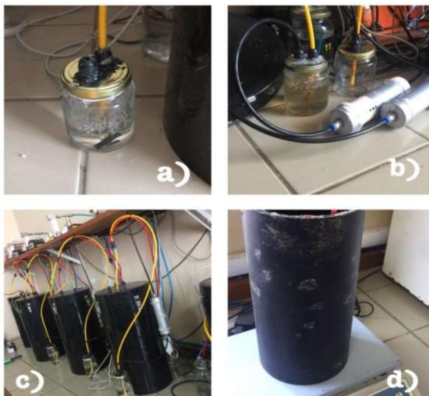
**Figura 12.** Biorreatores de bancada a) armadilha ácida para a coleta de amônia b) filtros de sílica e armadilhas ácidas c) biorreatores em funcionamento durante a compostagem d) pesagem do vaso interno cheio feito durante a amostragem.
