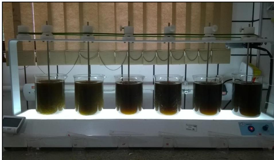
**Figura 9** - Ensaio de sorção com lixiviado e *Lithothamnium*.
