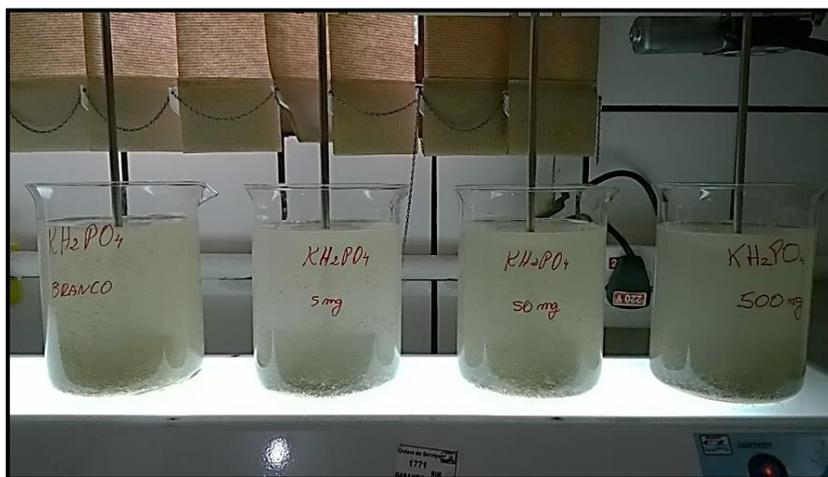
**Figura 4** - Ensaio de remoção de fósforo presente em solução padrão de  $\text{KH}_2\text{PO}_4$ , por *Lithothamnium*.
