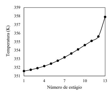
**Figura 32.** Gráfico do perfil da temperatura ao longo da coluna de destilação extrativa do sistema etanol - água - propilenoglicol.
