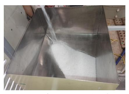
Figura 28 – Abastecimento de NaCl ao sistema de adição de sólidos.
