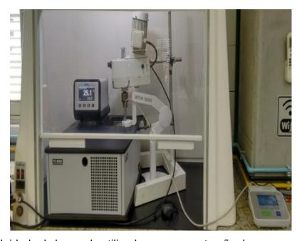
Figura 31 – Unidade de bancada utilizada para a construção das curvas de calibração.
