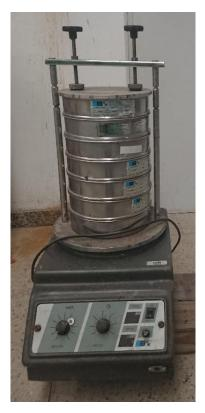
Figura 26 – Conjunto de peneiras e sistema vibratório.
