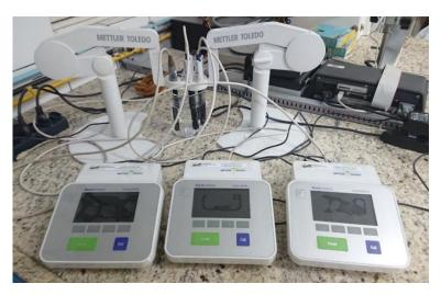
Figura 32 - Condutivímetros Metler Toledo SevenCompact S230.
