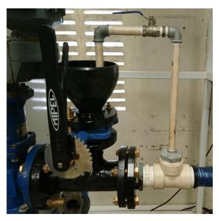
Figura 24 – Tubulação de efeito Venturi e sistema de by pass.
