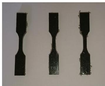
**Figura 21.** Corpos de prova confeccionados para ensaio de resistência à tração
