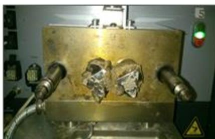
**Figura 16.** Obtenção das blendas de PEBDrec/PC-ABS no misturador de torque Thermo Scientific
