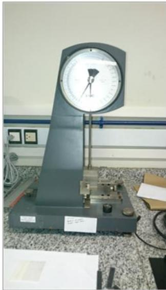
**Figura 22.** Máquina de ensaio impacto Izod
