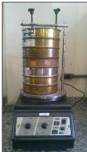
**Figura 15.** Separador granulométrico
