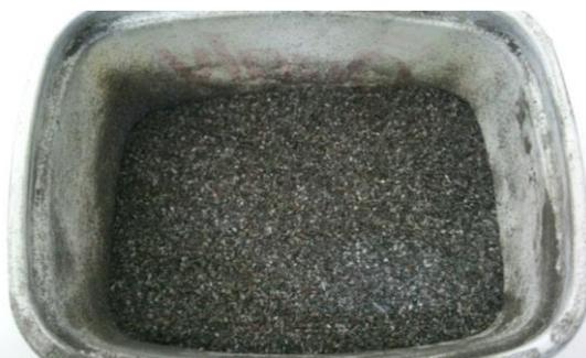
**Figura 14.** Carcaças de telefones celulares submetidas ao moinho de facas
