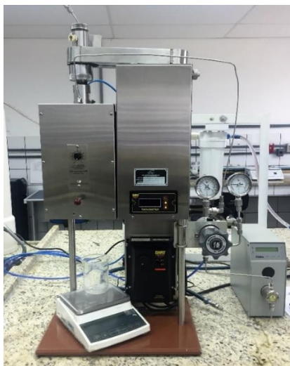
Figura 8 – Célula de filtração HTHP.
