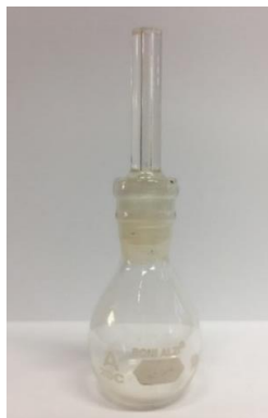
Figura 14 – Picnômetro utilizado para o ensaio.
