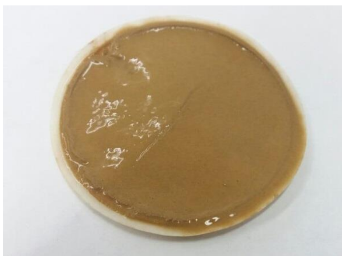
Figura 24 –Exemplo torta formada na filtração com o fluido GX e barita.
