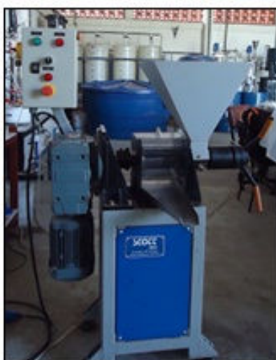
Figura 17- Prensa utilizada para a obtenção da torta
