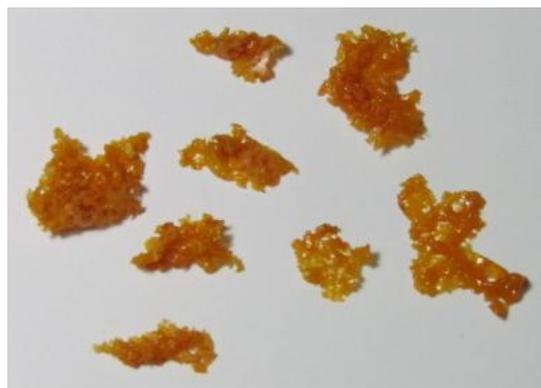
**Figura 9:** TPV - B (NBR/PS), 0,448g de emulsificante LSS e 450 rpm de agitação (adaptado de CAETANO, 2012)
