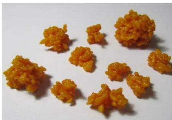
**Figura 11:** TPV - D (NBR/PS) 0,896g de emulsificante LSS e 620 rpm de agitação (adaptado de CAETANO, 2012)
