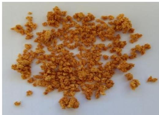
**Figura 39:** Grumos da mistura NBR/PMMA
