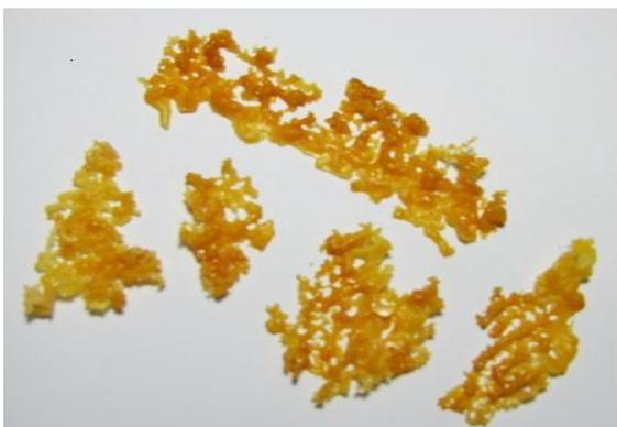
**Figura 8:** TPV - A (NBR/PS) 0,448g de emulsificante LSS e 400 rpm de agitação (adaptado de CAETANO, 2012)
