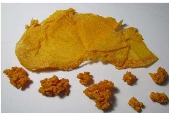
**Figura 10:** TPV - C (NBR/PS) 0,896g de emulsificante LSS e 400 rpm de agitação (adaptado de CAETANO, 2012)
