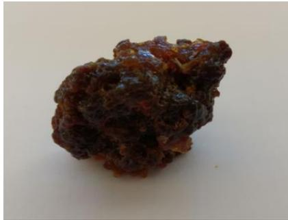
**Figura 30:** Grumo da mistura NR/PMMA
