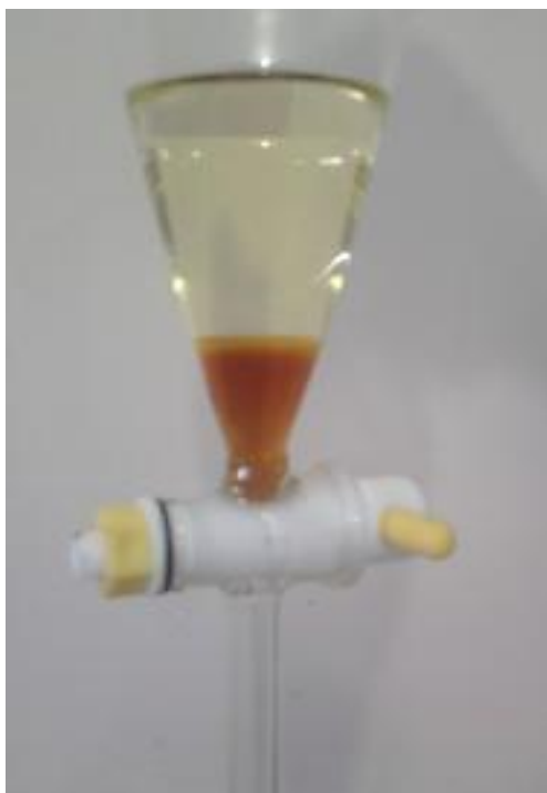
Figura 12 - Separação das fases de biodiesel e glicerol por gravidade
