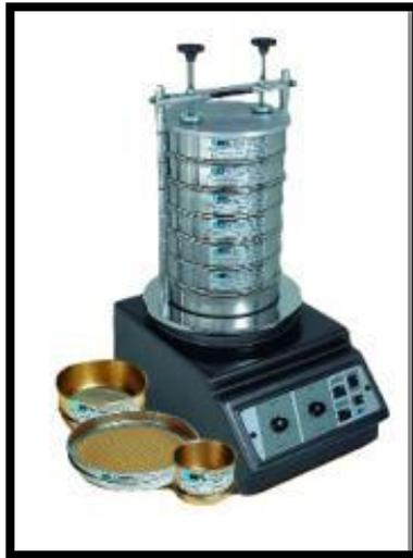
Figura 17. Agitador eletromagnético de peneiras. Fonte: BERTEL, 2017.
