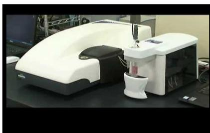
Figura 29. Equipamento Malvern Zetasizer Nano
