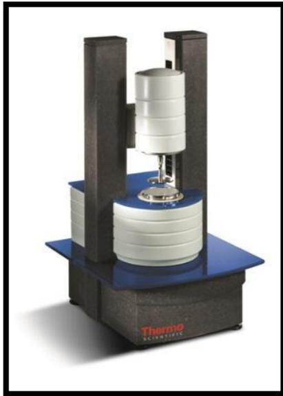
Figura 26. Reômetro HAAKE RheoStress 1 utilizado nos experimentos reológicos.
