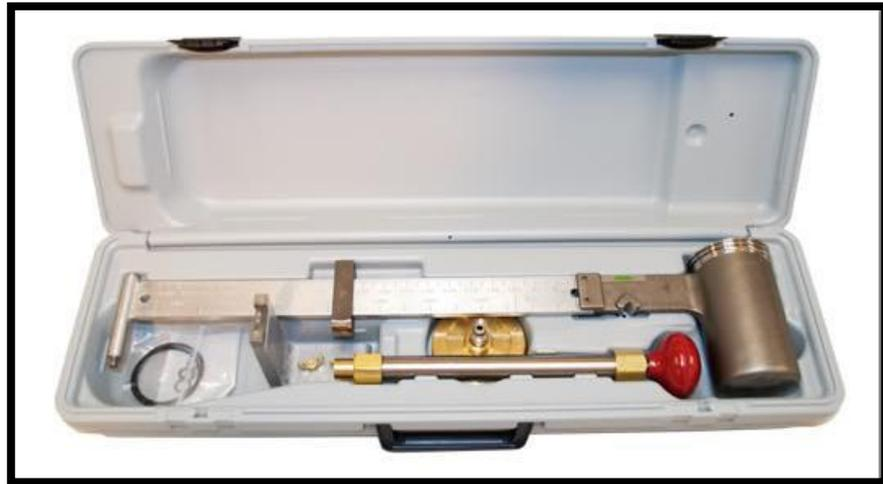
Figura 24. Balança de lama modelo Fann 140. Fonte: FANN, 2017
