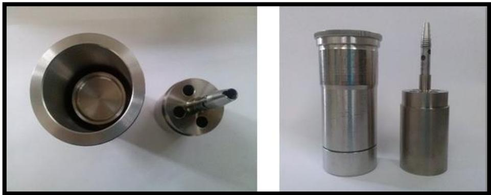
Figura 27. Geometria de cilindros coaxiais utilizada nos experimentos reológicos. À esquerda sua vista superior e à direita sua vista frontal.
