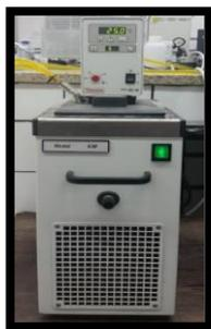
Figura 28. Banho termostático HAAKE K10 utilizado para controle da temperatura nos experimentos reológicos.
