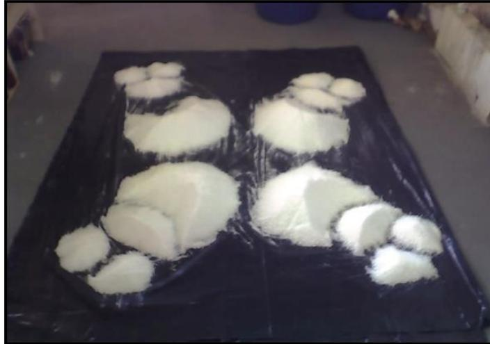
**Figura 22-** Foto da aplicação da técnica de quarteamento.
