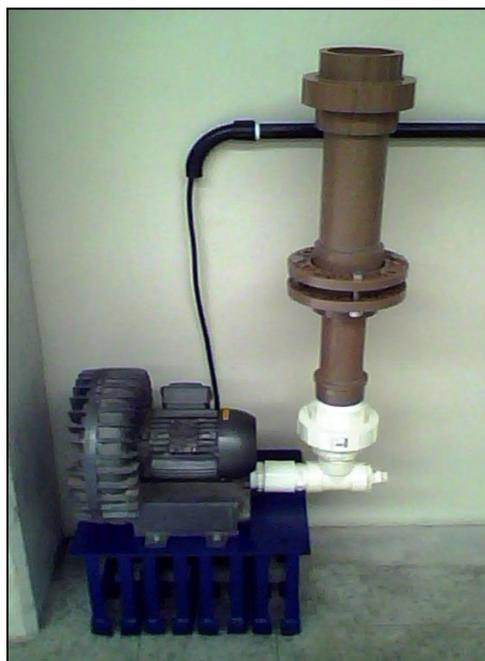
**Figura 33-** Foto da unidade de secagem do sal por convecção.
