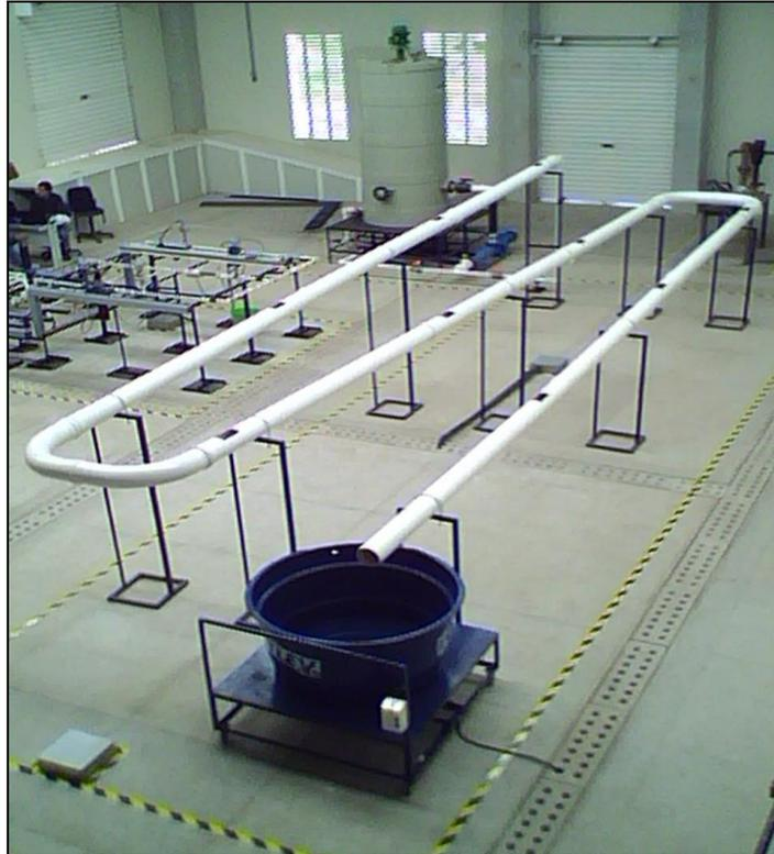
**Figura 20** - Foto da unidade experimental de escoamento de sais vista superior.
