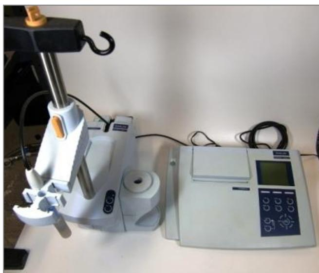
**Figura 26-** Foto do condutivímetro utilizado na determinação da concentração.
