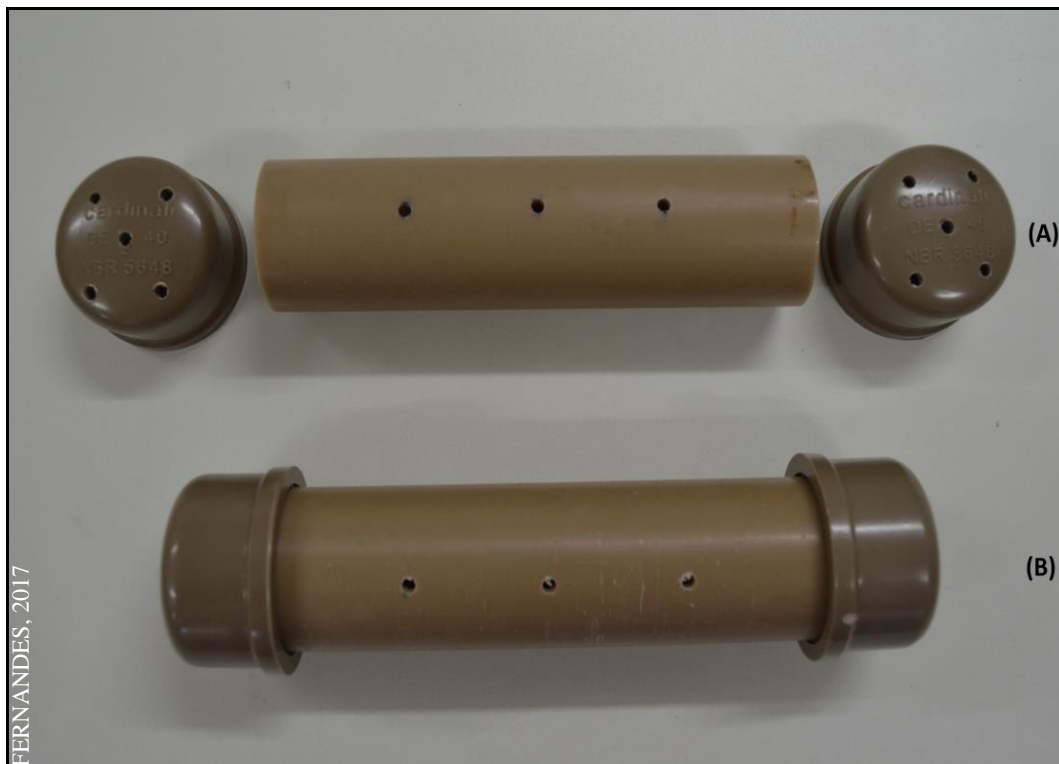
Figura 12. Porta-isca: (A) desmontado: tubo mais duas tampas e (B) montado.
