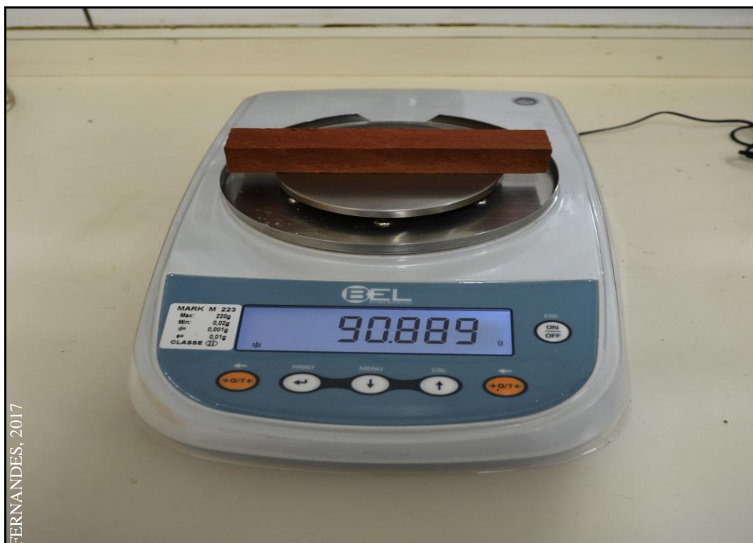
Figura 13. Balança eletrônica de precisão para pesagem das estacas.
