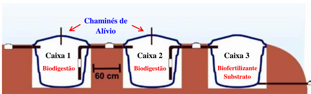
Figura 86: Esquema de funcionamento da fossa séptica
