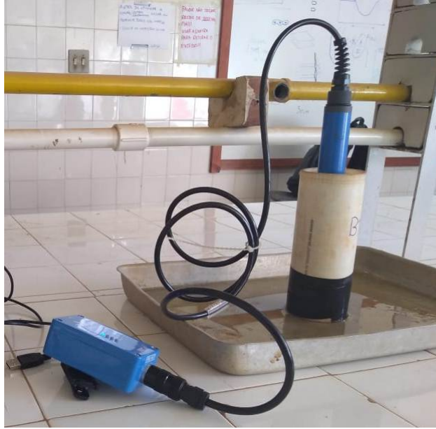
Figura B.11: Medição de umidade volumétrica e constante dielétrica com o sensor TDR.
