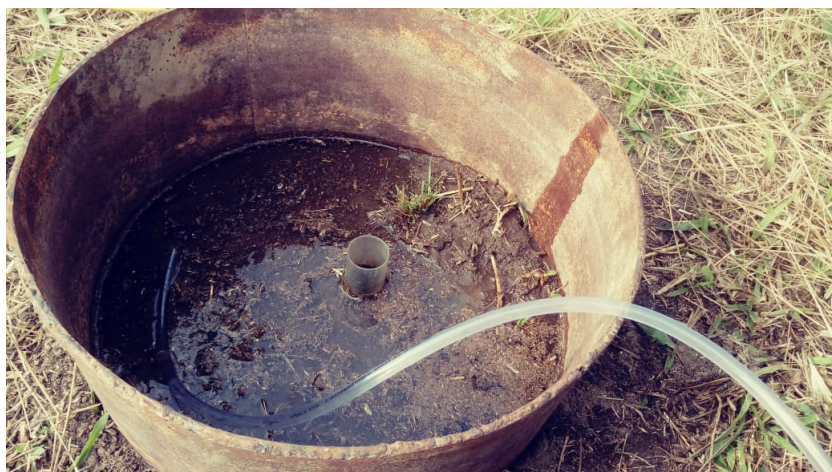
Figura B.8: Manutenção da carga hidráulica
