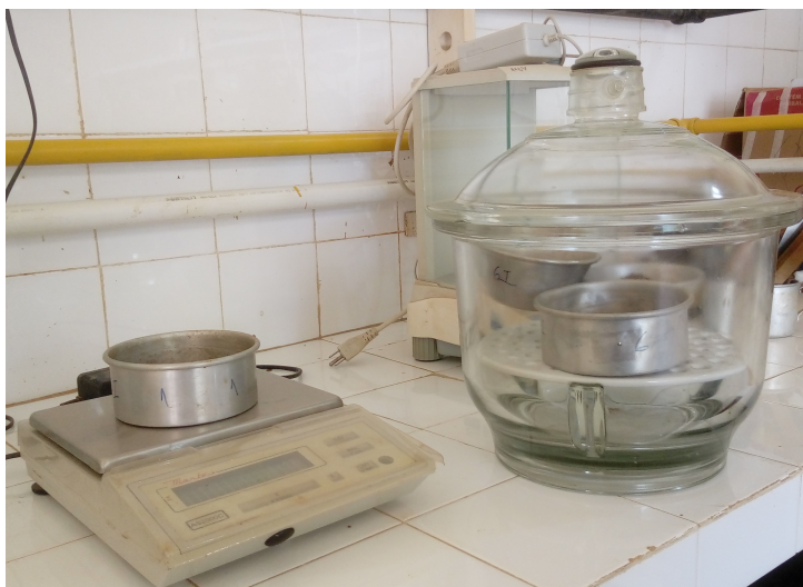
Figura B.12: Amostra sendo pesada e pronta para ser colocada na estufa.
