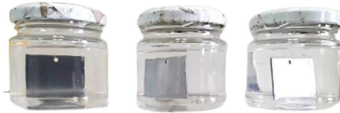
**Figura 11.** Esquema de placas de aço carbono AISI 1020 submersas em  $\text{H}_2\text{SO}_4$  1,0 mol  $\text{L}^{-1}$ .
