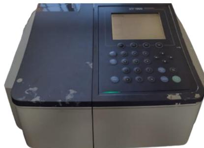
**Figura 12.** Espectrofotômetro UV-vis da marca Shimadzu, modelo UV-1800.
