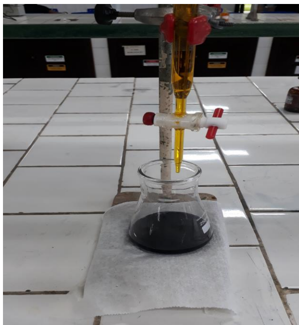
Figura 7: Determinação dicromatométrica do teor de Fe(II).
