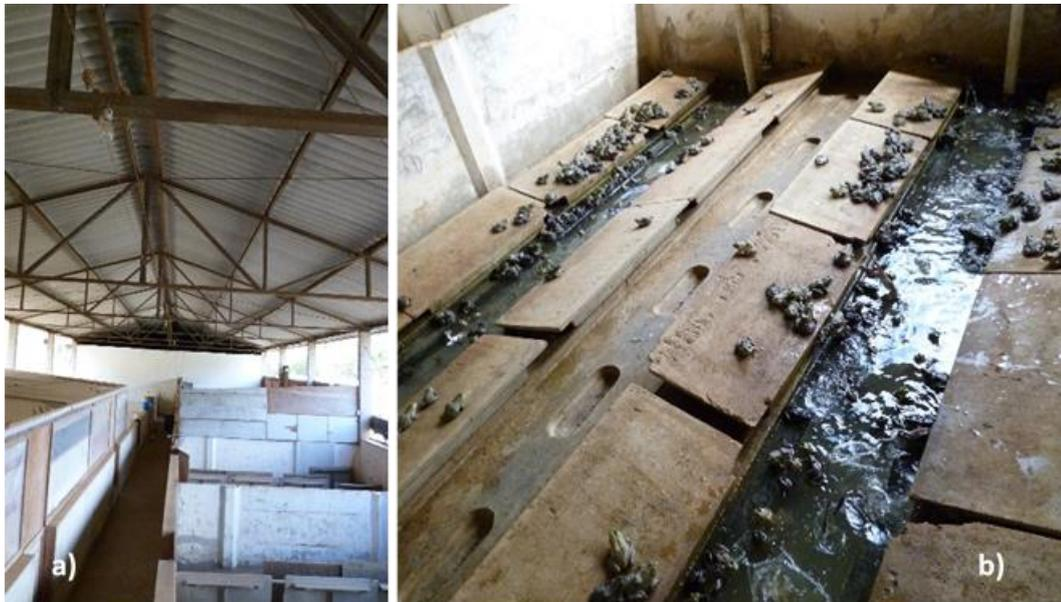
**Figura 2.** Ranário Experimental da Universidade Federal de Viçosa, a) Disposição das baias no galpão de alvenaria com cobertura de telha, b) Baia do sistema “anfigranja”, com as áreas seca com cochos, abrigos e a canaleta com água.
