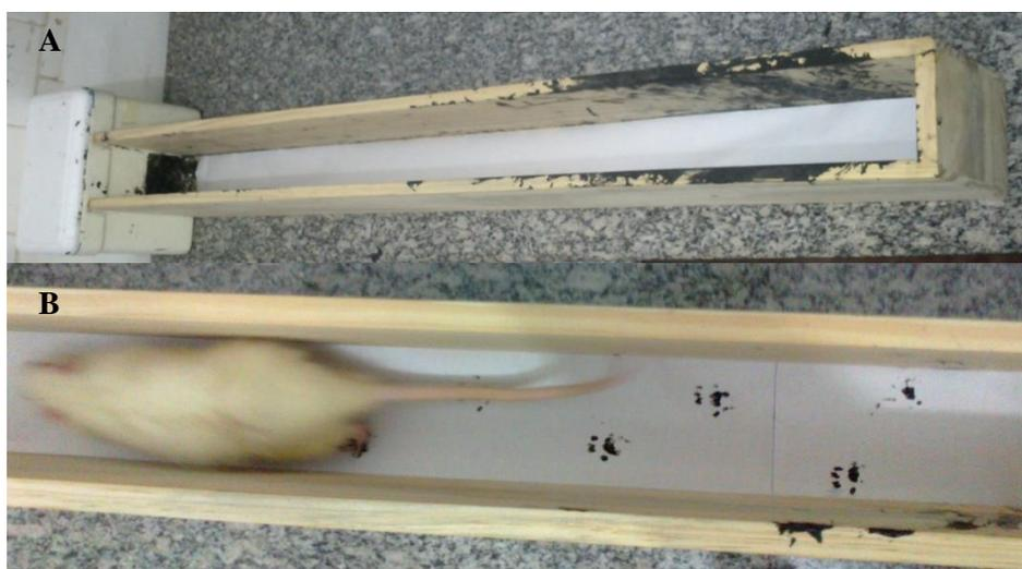
**Figura 21: Corredor utilizado no Teste Foot Print.** Em (A) observa-se a fita de papel colocada no assoalho deste corredor e a caixa colocada ao seu final, para onde os animais se dirigiam. Em (B), animal percorrendo o corredor contendo a fita de papel em seu assoalho onde as marcas das pegadas são obtidas após o animal ter tido suas patas traseiras pintadas.
