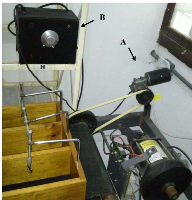
**Figura 17: Fotografia ilustrando a adaptação realizada na esteira.** Seta “A” indica o motor conectado por intermédio de uma correia ao eixo que movimenta a lona da esteira. Seta “B” indica o dispositivo eletrônico contendo um regulador (dimmer) que permitiu usar velocidades de 0 a 20 cm/seg.
