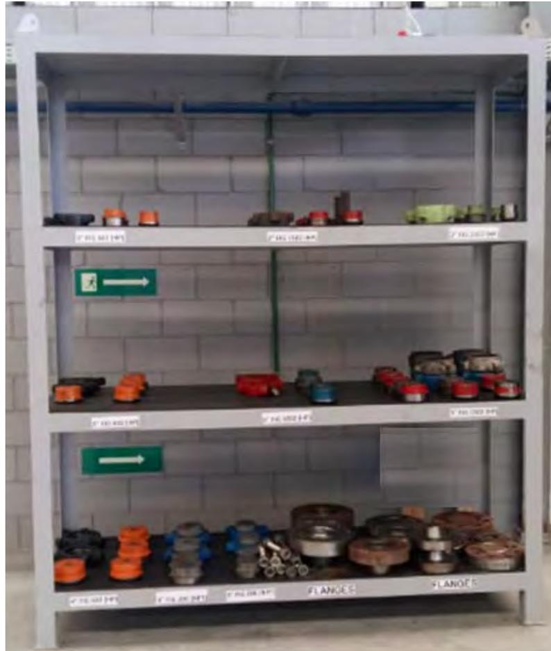
**Figura 22.** Ação de 5S para arrumação de acessórios de teste hidrostático. Fonte: elaboração própria.
