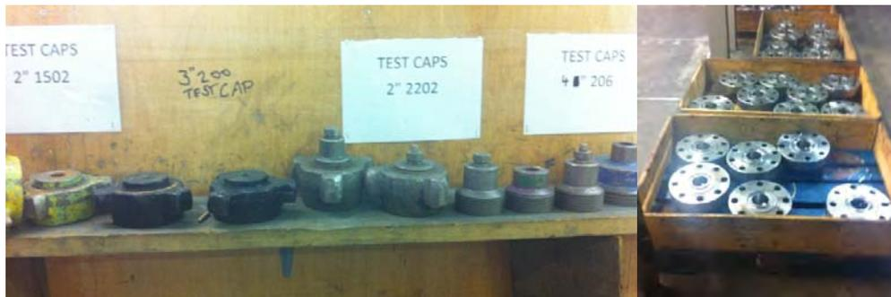
**Figura 16.** Acessórios de teste hidrostático – situação atual. Fonte: elaboração própria.
