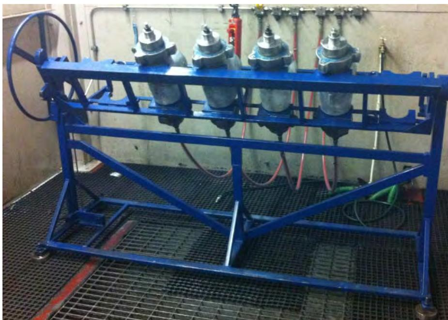
**Figura 19.** Dispositivo de teste hidrostático múltiplo. Fonte: elaboração própria.
