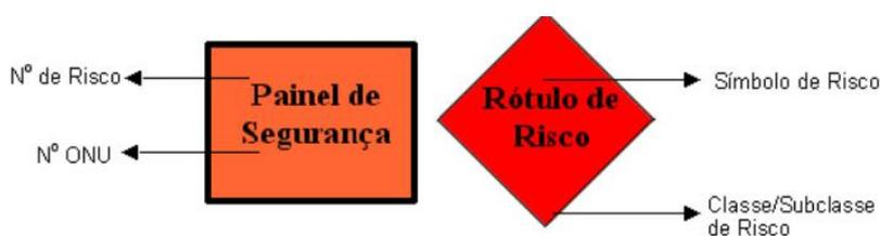
**Figura 2** - Identificação dos painéis de segurança segundo ONU
