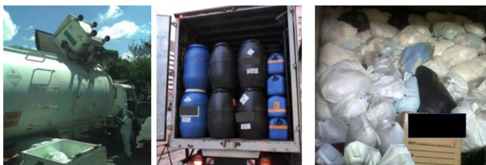
**Figura 18 – Caminhão compactador com opção de basculamento, caminhão carroceria fixa com coleta containerizada, e caminhão carroceria fixa com sacos sem mecanismos de proteção**
