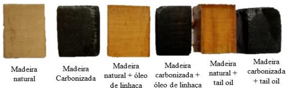
Figura 5. Corpos de prova após o tratamento térmico, associado à incorporação de óleos residuais da indústria de celulose.
