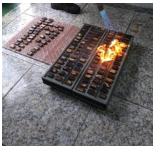
Figura 4. Corpos de prova sendo tratados termicamente com uma vassoura de fogo.
