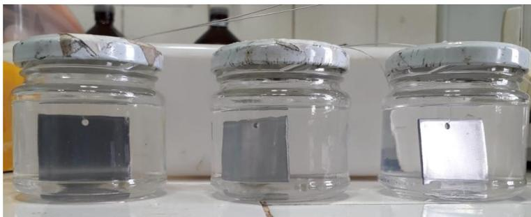
Figura 16. Esquema para realização do ensaio de perda de massa com as de placas de aço carbono AISI 1020 submersas na solução corrosiva.
