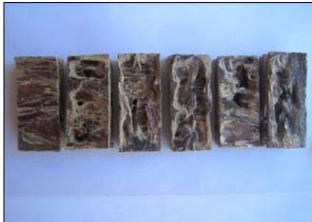
**Figura 6** Amostras de OSB de Chapa OSB de FF + TF<sub>(acácia)</sub> - (90:10), submetidas ao ataque de *C. gestroi*, por 45 dias
