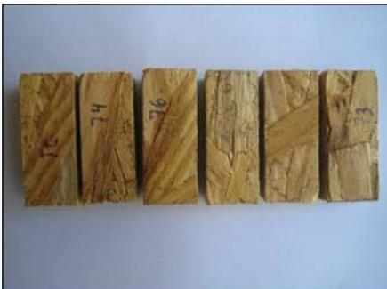
**Figura 8** Amostras de OSB comercial, submetidas ao ataque de *C. gestroi*, por 45 dias.
