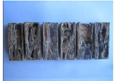
**Figura 4** Amostras de OSB de FF + TF<sub>(acácia)</sub> - (80:20), submetidas ao ataque de *C. gestroi*, por 45 dias
