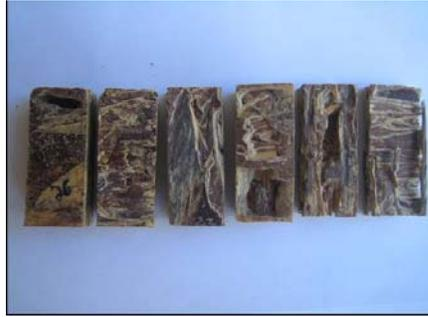
**Figura 3** Amostras de OSB de TF<sub>(acácia)</sub>, submetidas ao ataque de *C. gestroi*, por 45 dias
