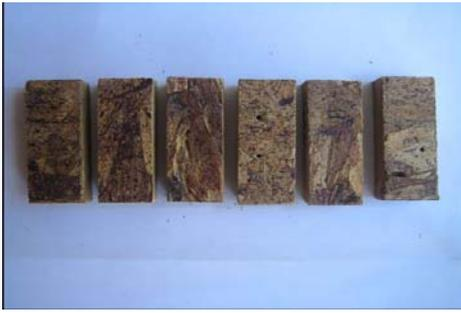
**Figura 2** Amostras de OSB de FF, submetidas ao ataque de *C. gestroi*, por 45 dias
