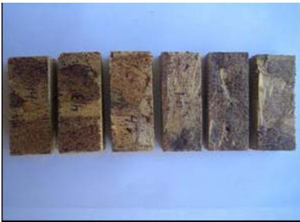
**Figura 5** Amostras de OSB de Chapa OSB de TF<sub>(acácia)</sub> + TF<sub>(casca E. pellita)</sub> - (80:20), submetidas ao ataque de *C. gestroi*, por 45 dias
