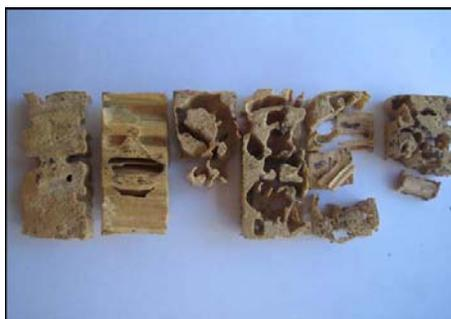
**Figura 9** Amostras de madeira de pinus, submetidas ao ataque de *C. gestroi*, por 45 dias
