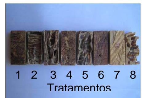
**Figura 10** Amostras de cada um dos tratamentos, submetidas ao ataque de *C. gestroi*, por 45 dias.
