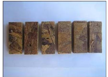
**Figura 7** Amostras de OSB de Chapa OSB de TF<sub>(acácia)</sub> + TF<sub>(casca E. pellita)</sub> - (90:10), submetidas ao ataque de *C. gestroi*, por 45 dias
