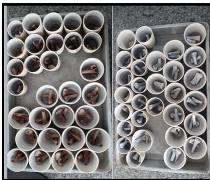
Figura 9. Ossos antes e pós queima em mufla para determinação de cinza óssea
