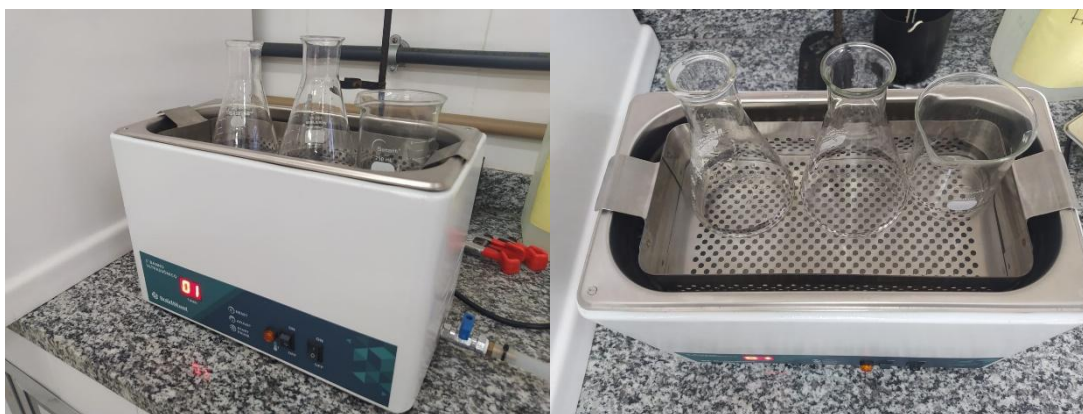
Figura 19. Dissolução de \text{AgNO}_3 e dissolução de Citrato de sódio em banho ultrassônico.
