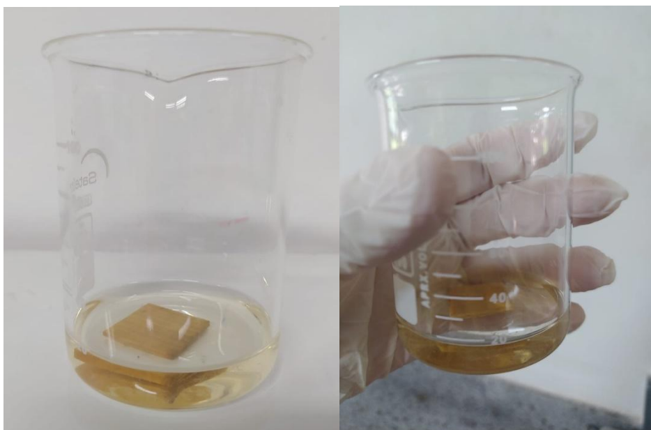
Figura 21. Amostra imersa em 20ml de solução de nanopartículas de prata (100ppm).
