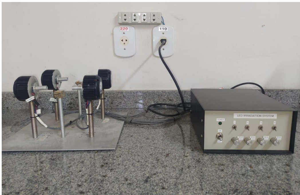
Figura 17. Aparato experimental para secagem de lâminas de madeira.
