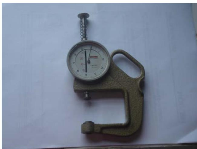
Figura 8. Medidor de espessura.
