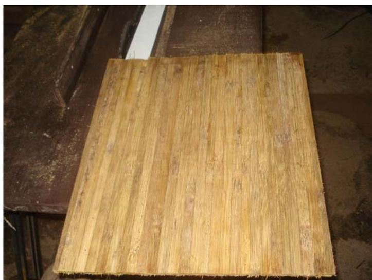
Figura 11. Compensado de bambu com dimensões de 50 cm x50 cm.
