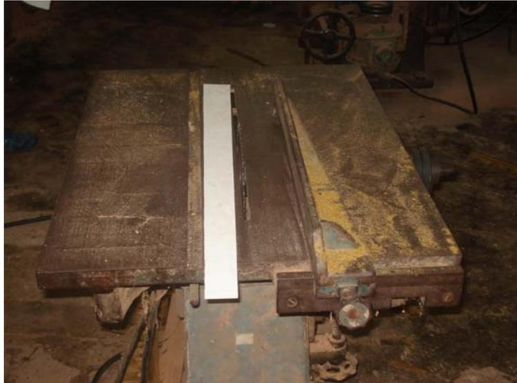
Figura 2. Serra circular utilizada para o desdobro dos bambus *Dendrocalamus giganteus*.
