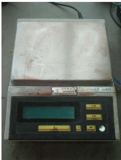
Figura 9. Balança digital (Marte).
