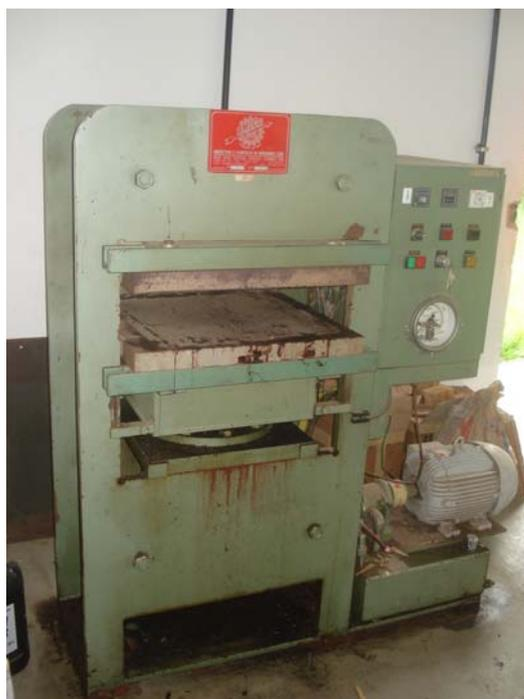
Figura 6. Prensa da com a dimensões dos pratos de 50 cm x 50 cm (Omeco).
