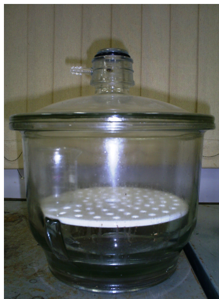
Figura 7: Dessecador utilizado para esfriamento das amostras.
