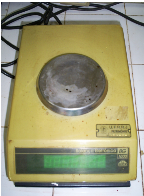
Figura 5: Balança eletrônica utilizada para pesagem da amostra.
