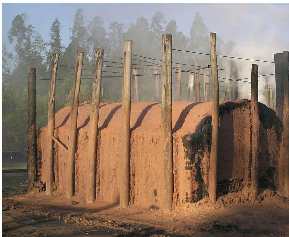
Figura 10: Forno do tipo Superfície com Chaminé
