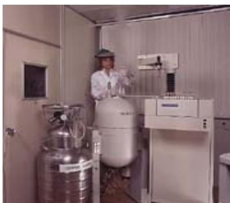
**Figura 8.** Espectrômetro da marca VARIAN Mercury plus utilizada para a obtenção dos espectros.
