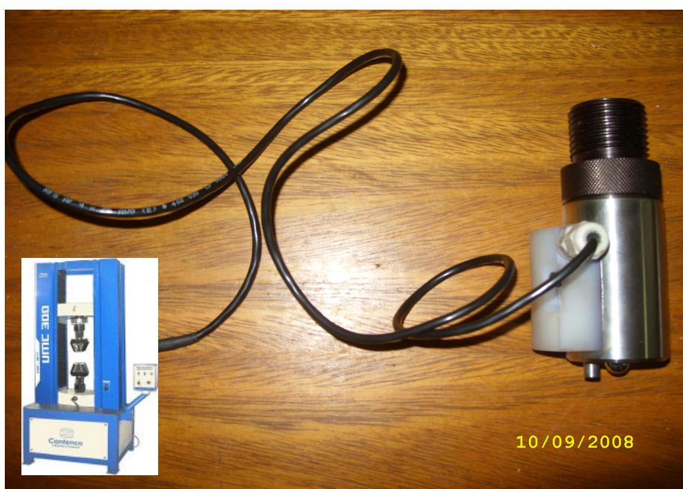
Figura 2. Dispositivo utilizado no ensaio da Dureza Janka (no detalhe, visualiza-se a máquina de ensaio utilizada).
